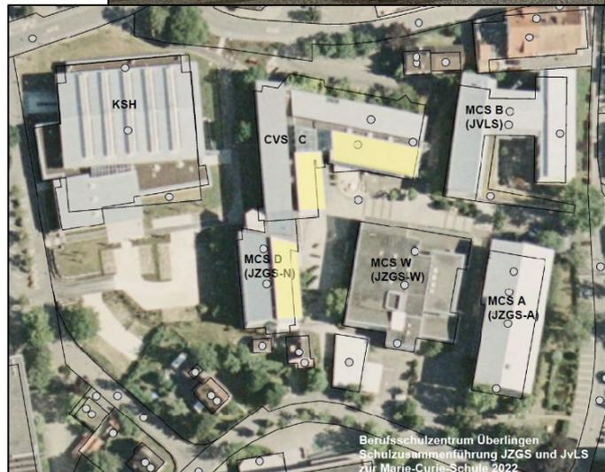
Zum gesamten BSZ ÜB gehören drei Schulgebäude, ein Werkstattgebäude sowie eine Sporthalle. Die Wärmeversorgung erfolgt über zwei unabhängige dezentrale Heizzentralen die mit Gas und teilweise auch noch mit Heizöl betrieben werden können. Für 2024 ist geplant, für den Schulcampus ein Energie-Effizienz-Contracting (EE-C) in der Zusammenarbeit mit der KEA-BW auszuschreiben.
